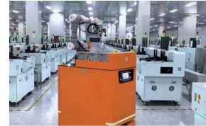
Die Bonder Loading & Unloading
